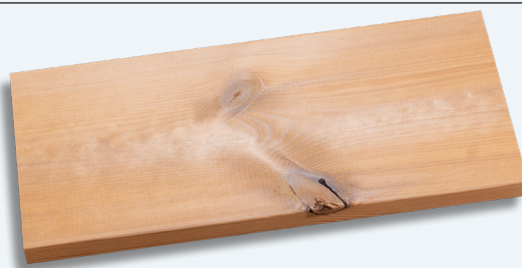
Teilweise fest verwachsene Kantenäste
