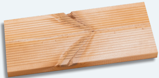
Bretter mit Funktionsbeeinträchtigungen und Bruchgefahr
