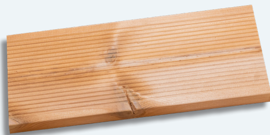
Kantenäste mit Rissen
