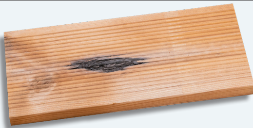
Bretter mit Fäulnis und faulen Ästen
