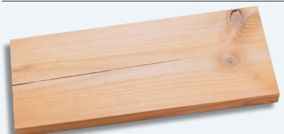
Moderate Endrisse, die sauber geschnitten werden können (max. 10 cm)
