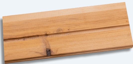
Fehlende moderate Kantenäste (< 10mm)
