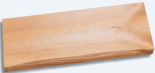
Kleine Kantenschäden bis 30 cm
