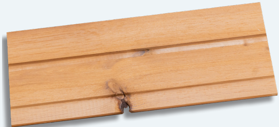
Mängel, die nach der Montage nicht sichtbar sind
