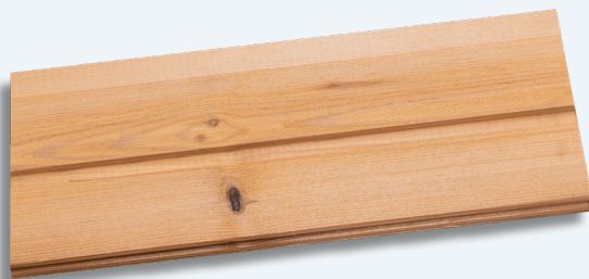
Ausgefallene Äste ohne Durchgangsloch (< 6mm)
