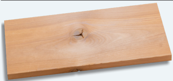
Äste mit sternförmigen Rissen, entstanden durch die Thermobehandlung
