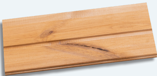
Fest verwachsener Flügelast
