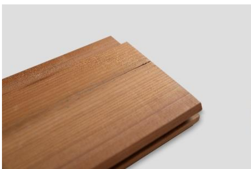
Generell können im Bereich von 8cm vor der Stirnseite Mängel nicht ausgeschlossen werden
